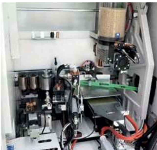
Unidad encoladora para la aplicación automática de cantos en rollo y tiras de 0,4 a 12 mm.
